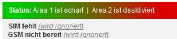
Die App „Systemstatus“ zeigt Ihnen alle aktuell wichtigen Meldungen. So zeigt Ihnen das Beispiel oben, dass Area 1 gerade scharf geschaltet ist und Area 2 nicht. Außerdem zeigt Sie an, dass noch keine SIM Karte installiert wurde und demnach das GSM Modul nicht bereit ist. Diese Fehler wurden allerdings vom Benutzer ignoriert.
