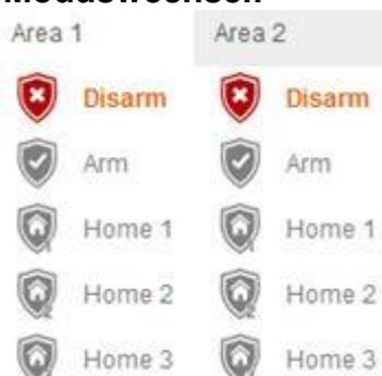
Mit dieser Funktion ist es möglich den Zustand beider Areas der Alarmanlage (unscharf, scharf, Home-Modi 1-3) zu wechseln. Sie sehen auf einem Blick den aktuellen Zustand beider Areas (orange hinterlegt).
