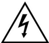
Dieses Symbol soll den Benutzer auf möglicherweise ungeschützte gefährliche Spannungen innerhalb des Gehäuses hinweisen. Diese können unter Umständen einen elektrischen Schlag auslösen.
