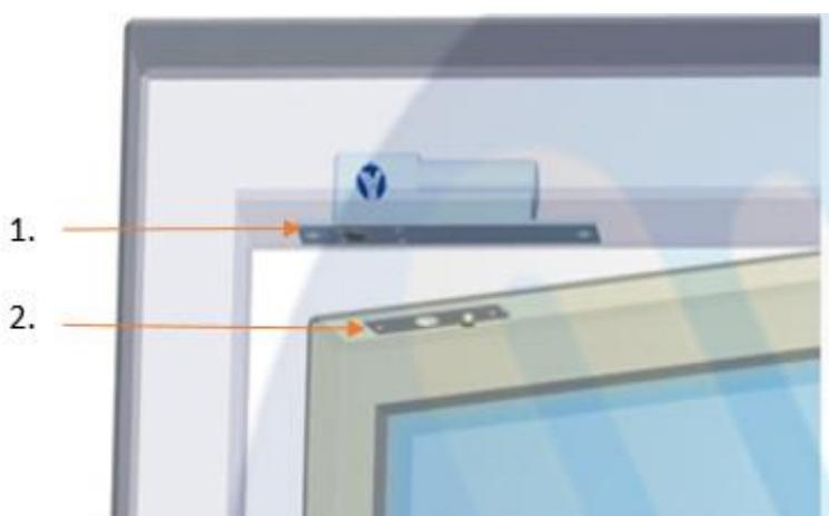
1. Mechanisches Sperrelement
