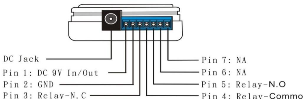
Pin 1 + 2 liefern einen konstanten 9V DC Ausgangstrom. Pin 1 hat + Polarität, Pin 2 -.
