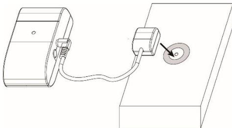
3. Führen Sie das Kabel des IR Sensors, für eine bessere Funkübertragung, aus dem Sicherungskasten und schließen Sie es an den IR Sensor Anschluß (4).
