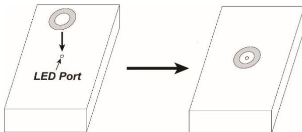
2. Der IR Sensor des Hauptstromzählers hat einen Magneten. Befestigen Sie den Sensor so auf der Unterlegscheibe, dass er freien Zugang zur IR Schnittstelle Ihres Sicherungskastens erhält.
