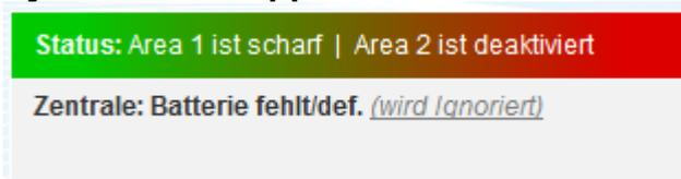
Die App „Systemstatus“ zeigt Ihnen alle aktuell wichtigen Meldungen. So zeigt Ihnen das Beispiel oben, dass Area 1 gerade scharf geschaltet ist und Area 2 nicht. Außerdem zeigt Sie an, dass der Notstrom Akku (Batterie) der Alarmanlage nicht aktiviert wurde oder noch nicht geladen ist. Dieser Fehler wurde allerdings vom Benutzer ignoriert.
